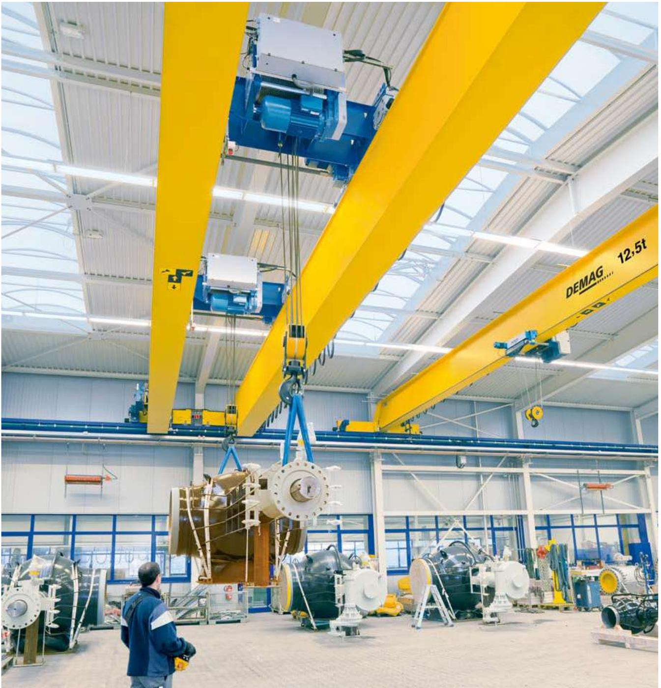
Las grúas de dos vigas posibilitan una elevada capacidad de carga, y al mismo tiempo un manejo más cuidadoso de la carga, mediante la regulación de velocidad sin escalonamientos en los tres ejes, también en el funcionamiento tándem.
